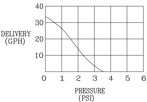
TYPICAL PRESSURE VS. DELIVERY CURVE AT NOMINAL VOLTAGE. ZERO HEAD ON FUEL INLET AND OUTLET. FUEL — COMMERCIAL GASOLINE
